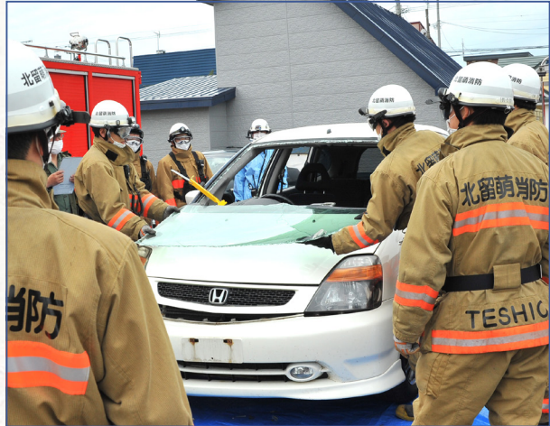
▼車両の窓ガラスを特殊工具を用いて取り外す様子
