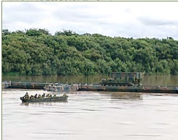
▼架けられた浮き橋を車両が渡っていく
